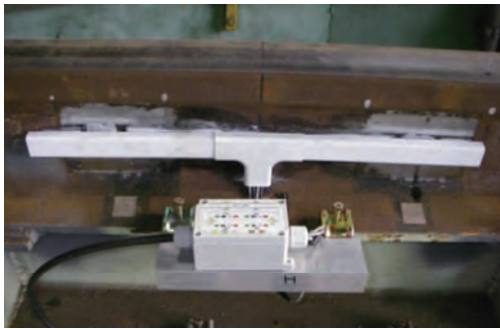
● 輪重バランス計測装置 ●
