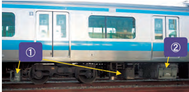
● ①軌道変位モニタリング装置 ②軌道材料モニタリング装置 ●
