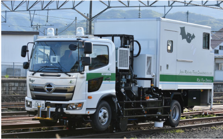
軌道載線時の軌陸式レール探傷車
